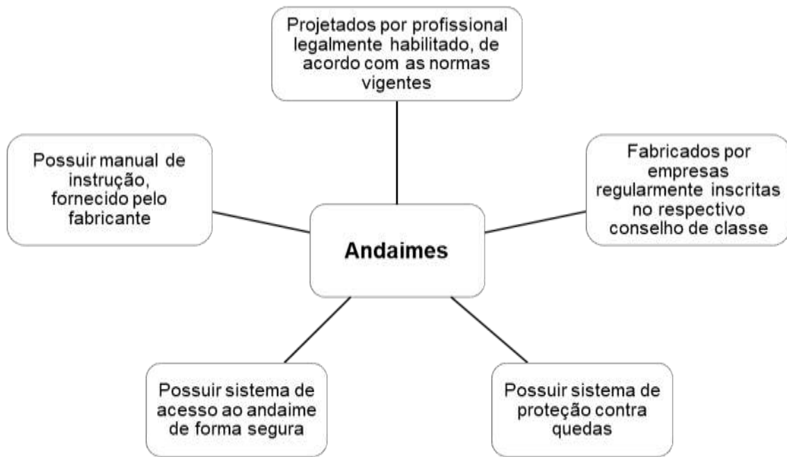
Figura 12 - Requisitos para utilização de andaimes
