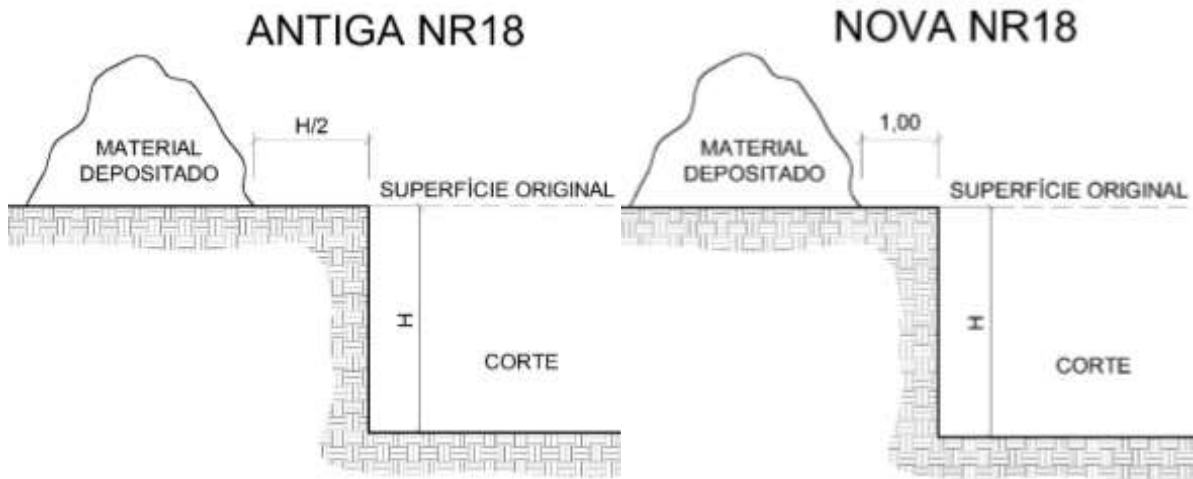
Figura 5 - Área de proteção da borda da escavação
