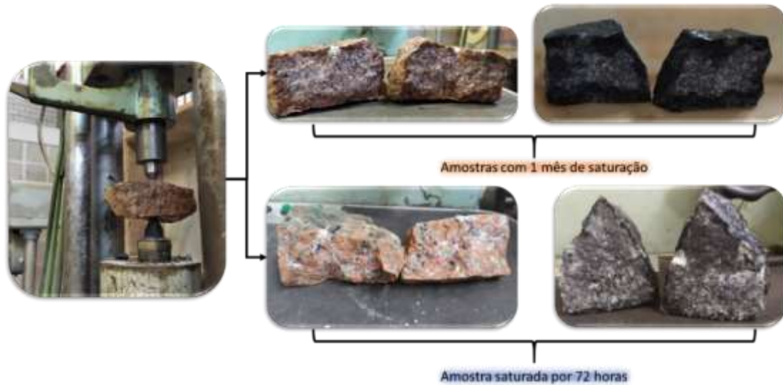
Figura 4 Representação da amostra submetida ao ensaio de carga pontual sob duas condições: saturada por 72 horas e saturado por 30 dias.
