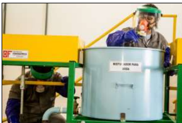
Figura 4 – Foto do misturador de soda cáustica Fonte: Coordenador do projeto (2020).
