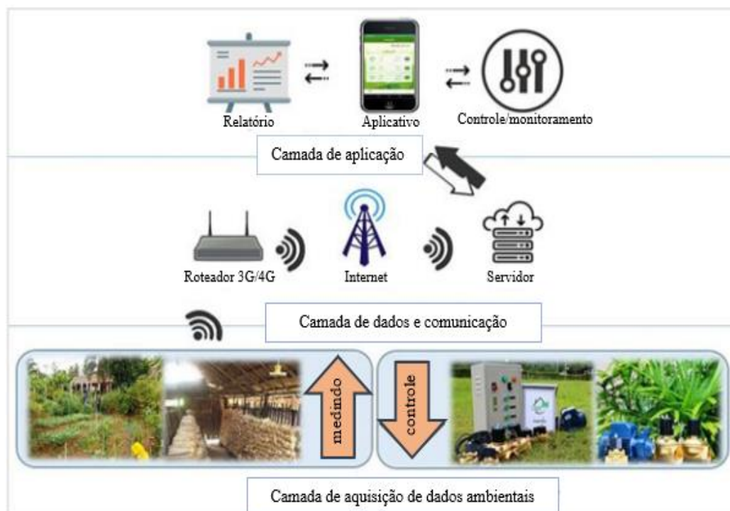
Figura 3 – Arquitetura de um sistema para controle da irrigação. Fonte: Adaptado de DANY; SHUMING (2019).
