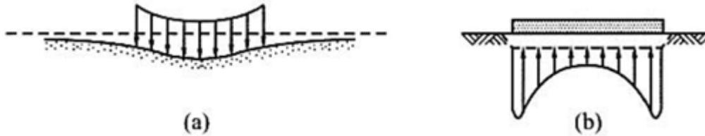
Figura 8 – Tensão de contato entre sapata e argila (Cintra, Aoki e Albiero, 2003).
