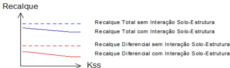
Figura 7 - Recalque x rigidez relativa estrutura. (Lopes e Gusmão, 1991)
