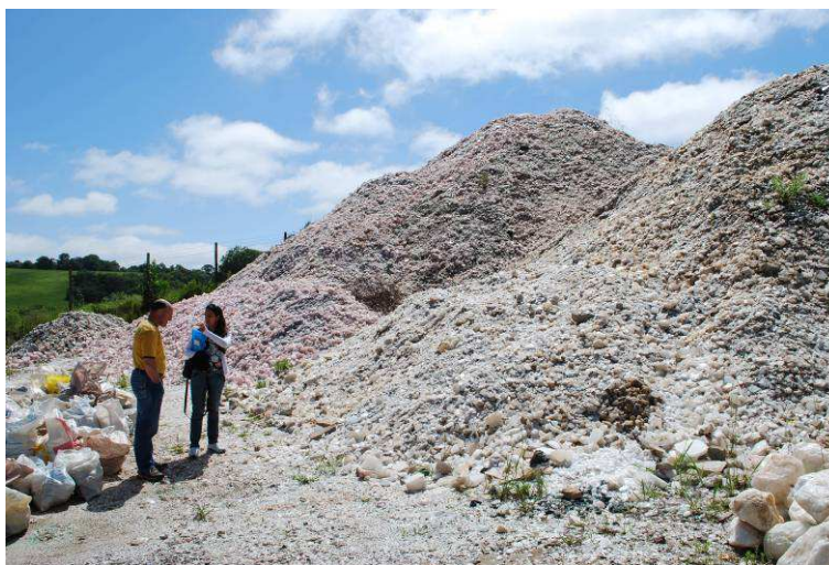
Figura 1: Pilha de rejeitos em empresa de Pedras Preciosas de Soledade/RS.
