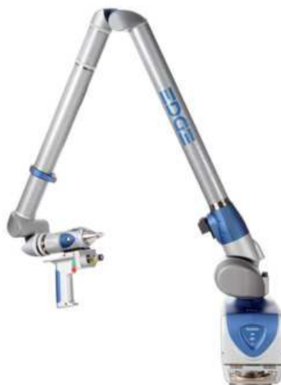
Figura 6 - Braço de Medição Tridimensional FARO.
