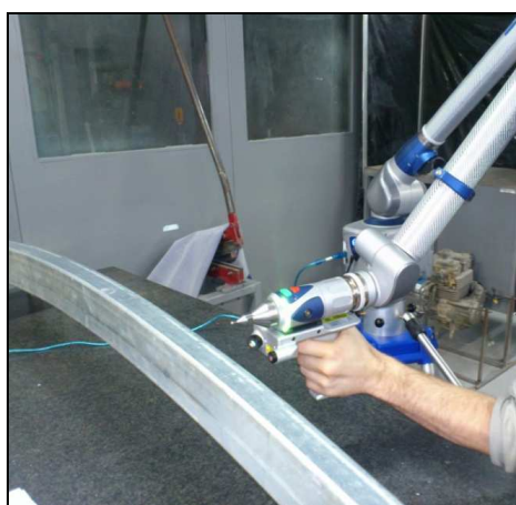
Figura 9 - Processo de coleta da nuvem de pontos.
