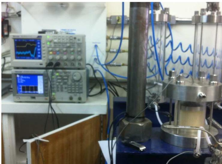
Figura 6: Realização do ensaio de determinação da rigidez.
