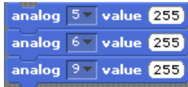
Figura 6: PWM na IDE S4A, as três portas com valores de 255 ligadas.
