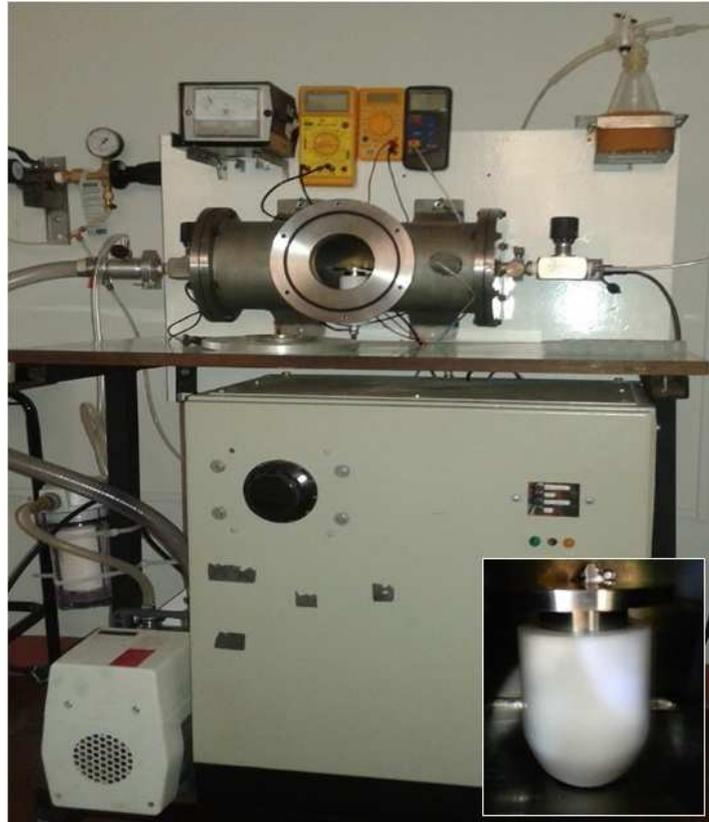
Figura 3: Reator finalizado. No detalhe a base onde é gerado o plasma com o isolamento de teflon.
