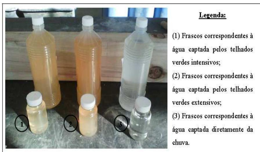
Figura 9: Frascos cheios, após coleta de água da chuva.
