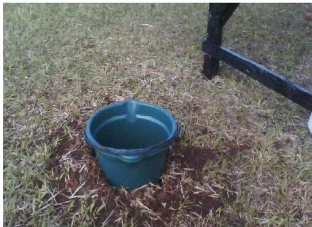
Figura 8: Recipiente que armazena diretamente a água da chuva
