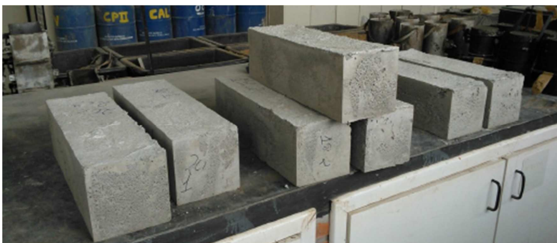
Figura 4 – Blocos de concreto celular. Blocos com diferentes teores de cinza volante.
