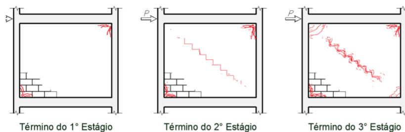
Figura 1 – Estágios do comportamento de alvenaria de contraventamento
