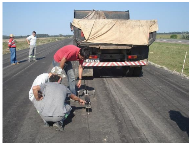
Figura 3: Levantamentos deflectométricos com a viga Benkelman
