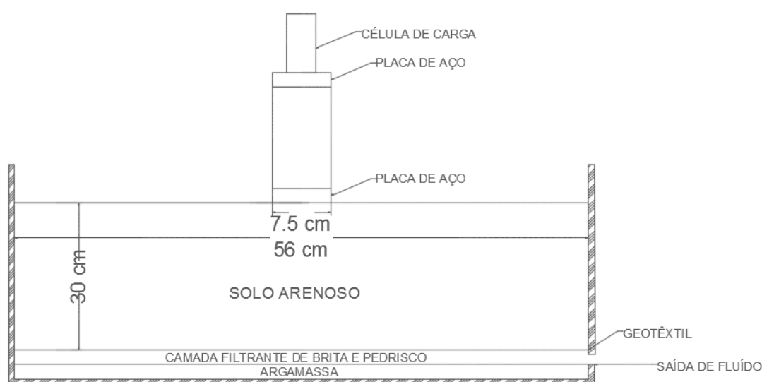
Figura 4 – Corte esquemático da aplicação do ensaio de placa
