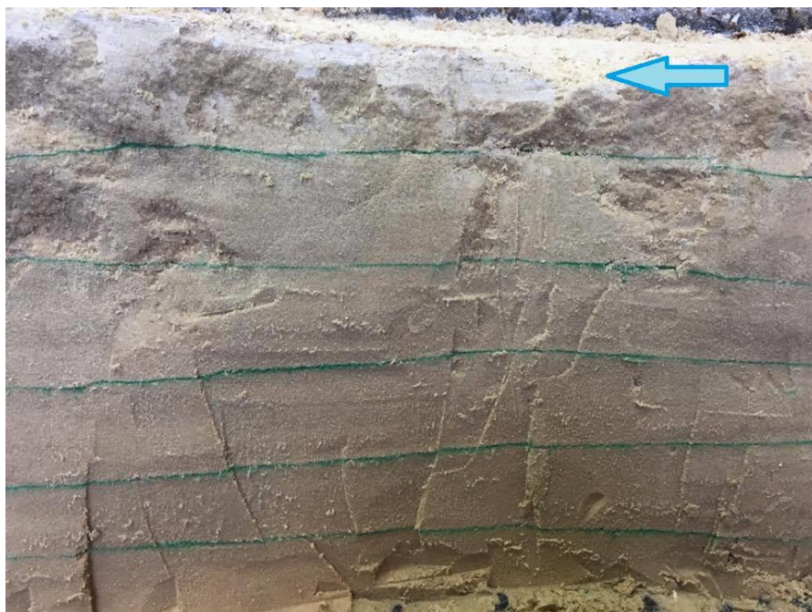
Figura 15 – Corte transversal do CP_03Biocimentado
