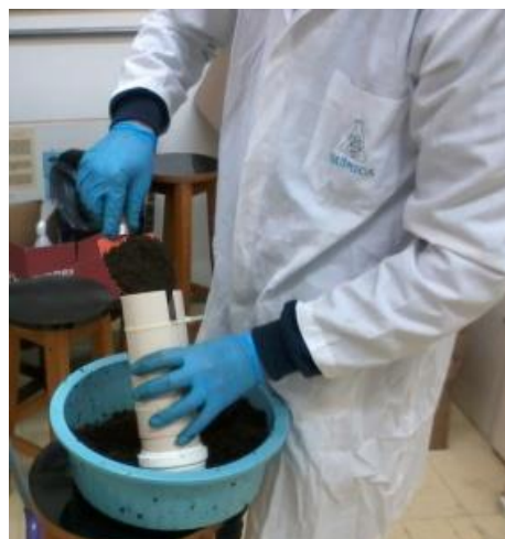
Figuras 4 - Contaminação dos materiais de biodegradação (composto e vermicomposto) e preenchimento das colunas.
