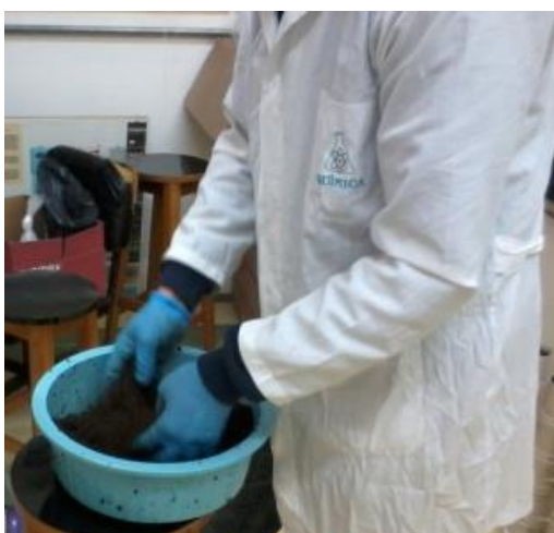
Figuras 4 - Contaminação dos materiais de biodegradação (composto e vermicomposto) e preenchimento das colunas.
