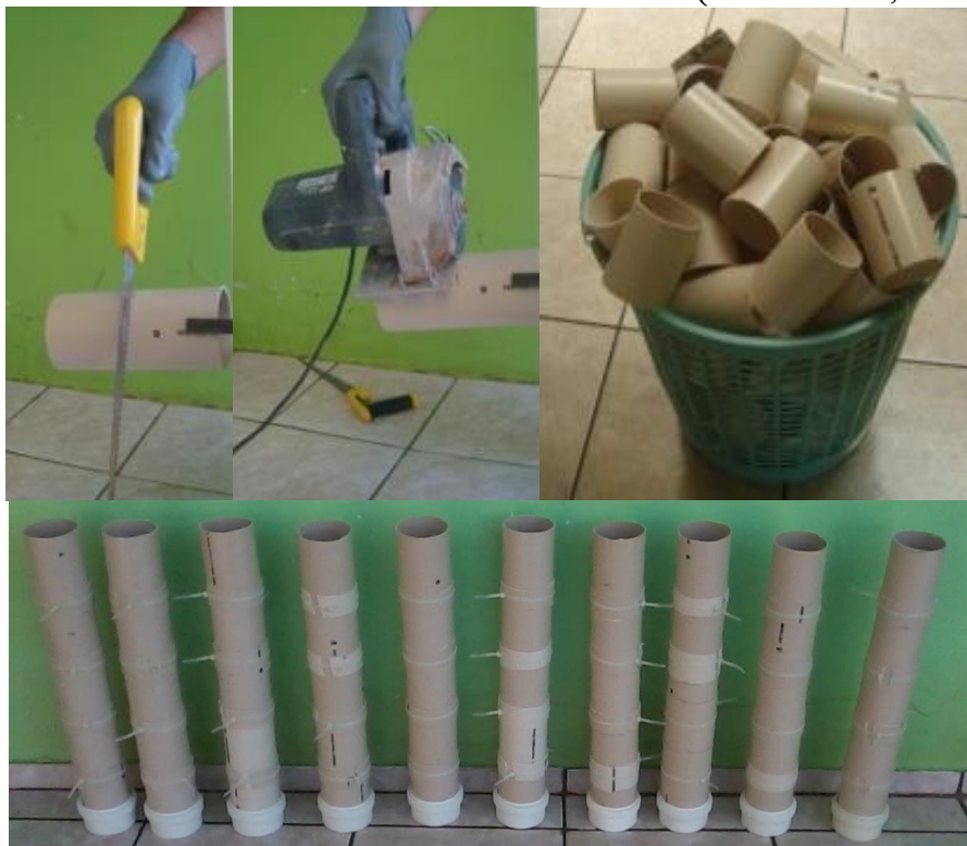
Figura 2 - Construção da coluna de biodegradação e visão geral das colunas.
