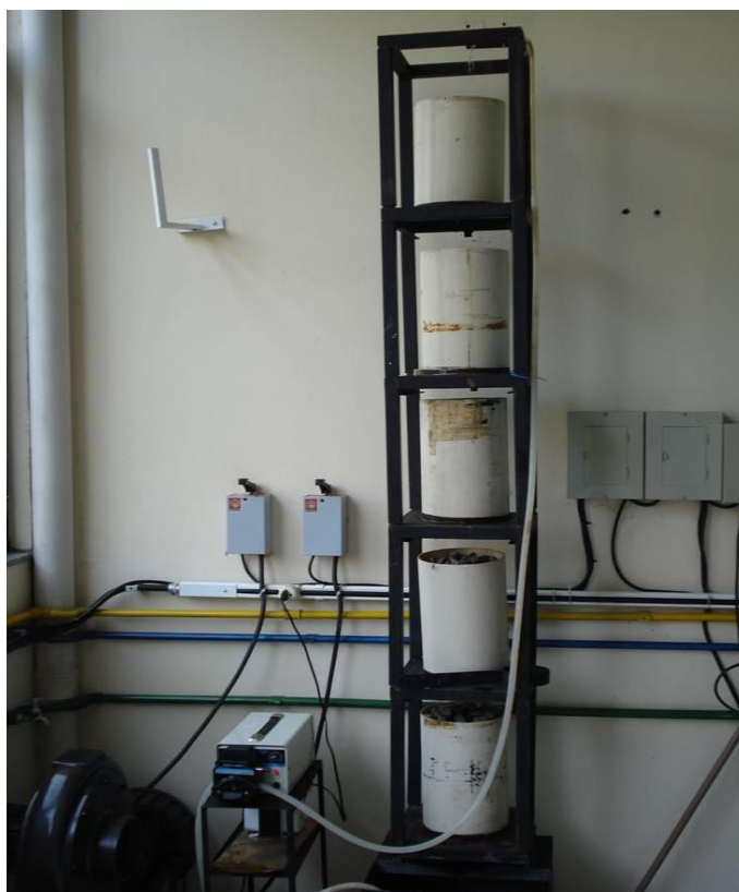
Figura 2. Filtro biológico em escala de bancada
