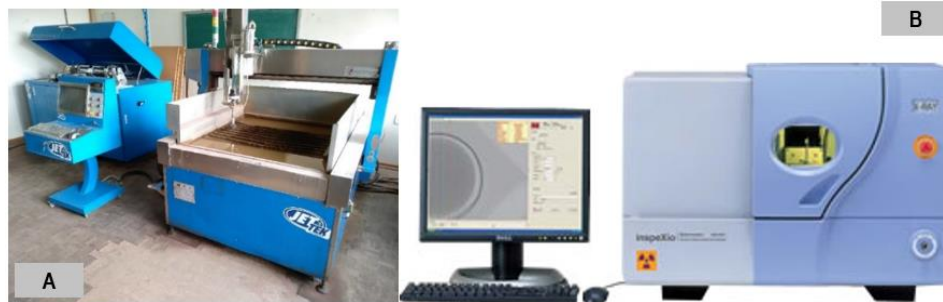
Figura 2 – Equipamentos utilizados na execução e análises do experimento. Em A) máquina de corte a jato de água abrasivo, em em B) equipamento de microtomografia de raios X.
