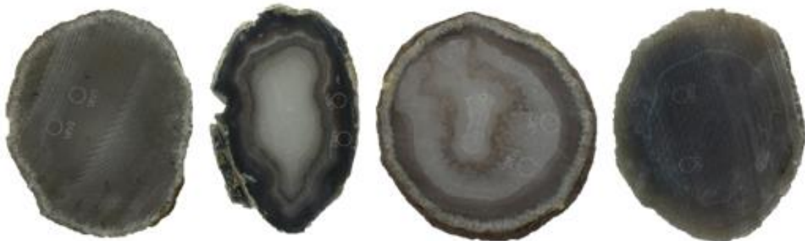
Figura 10 - Amostras de lâminas de ágata com numeração 18, da categoria “vidrada” (18V1 e 18V2), seguida da categoria “bandada” (18B1 e 18B2), “sal” (18S1e 18S2) e “massa” (18M1 e 18M2), da esquerda para a direita. Amostras antes do tingimento em rosa orgânico, para a concentração 2.
