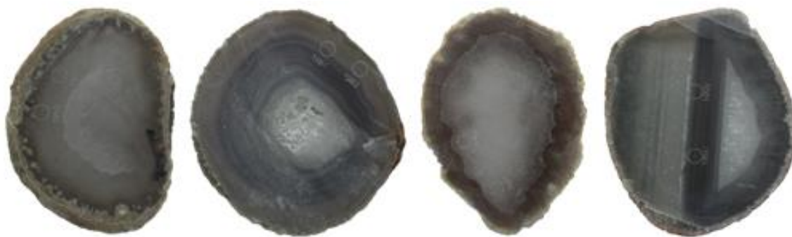
Figura 12 - Amostras de lâminas de ágata com numeração 19, da categoria “vidrada” (19V1 e 19V2), seguida da categoria “bandada” (19B1 e 19B2), “sal” (19S1e 19S2) e “massa” (19M1 e 19M2), da esquerda para a direita. Amostras submetidas ao tingimento em rosa orgânico, para a concentração 3, antes do tingimento.
