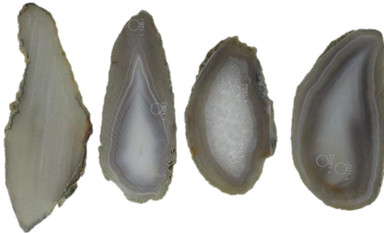
Figura 18 - Amostras de lâminas de ágata com numeração 114, da categoria “vidrada” (114V1 e 114V2), seguida da categoria “bandada” (114B1 e 114B2), “sal” (114S1 e 114S2) e “massa” (114M1 e 114M2), da esquerda para a direita. Amostras antes do tingimento convencional em rosa, a base de corante orgânico.
