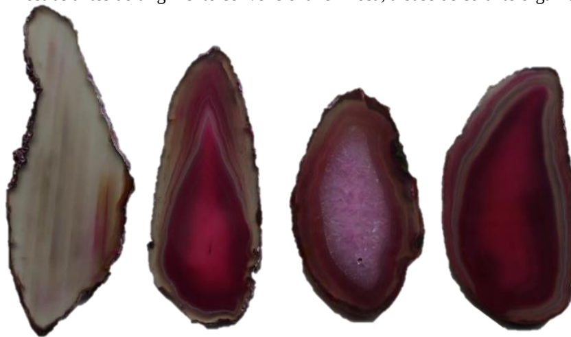
Figura 19 - Amostras de lâminas de ágata com numeração 114, da categoria “vidrada” (114V1 e 114V2), seguida da categoria “bandada” (114B1 e 114B2), “sal” (114S1 e 114S2) e “massa” (114M1 e 114M2), da esquerda para a direita. Amostras submetidas ao tingimento convencional em rosa, a base de corante orgânico, após polimento.
