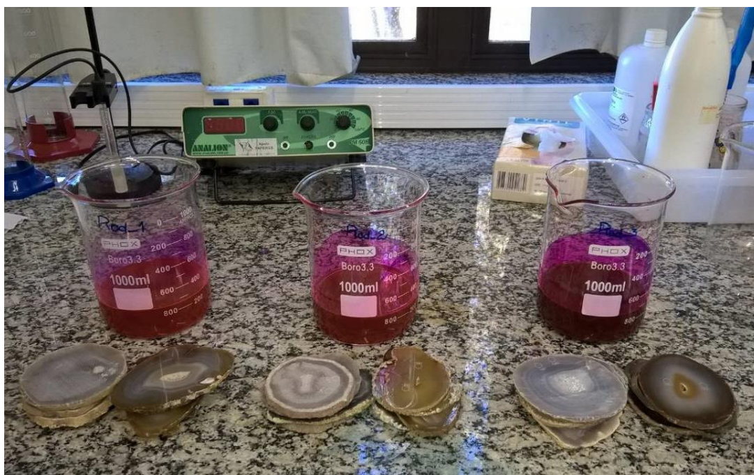
Figura 6 - Vista geral dos lotes de ágatas submetidos ao tingimento otimizado na tonalidade rosa.
