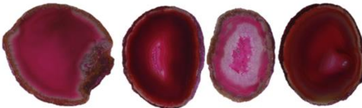
Figura 15 - Amostras de lâminas de ágata com numeração 5, da categoria “vidrada” (5V1 e 5V2), seguida da categoria “bandada” (5B1 e 5B2), “sal” (5S1e 5S2) e “massa” (5M1 e 5M2), da esquerda para a direita. Amostras submetidas ao tingimento em rosa orgânico, para a concentração 4, após polimento das peças.
