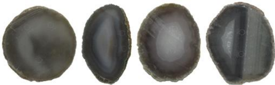
Figura 8 - Amostras de lâminas de ágata com numeração 17, da categoria “vidrada” (17V1 e 17V2), seguida da categoria “bandada” (17B1 e 17B2), “sal” (17S1e 17S2) e “massa” (17M1 e 17M2), da esquerda para a direita. Amostras antes do tingimento em rosa orgânico, para a concentração 1.
