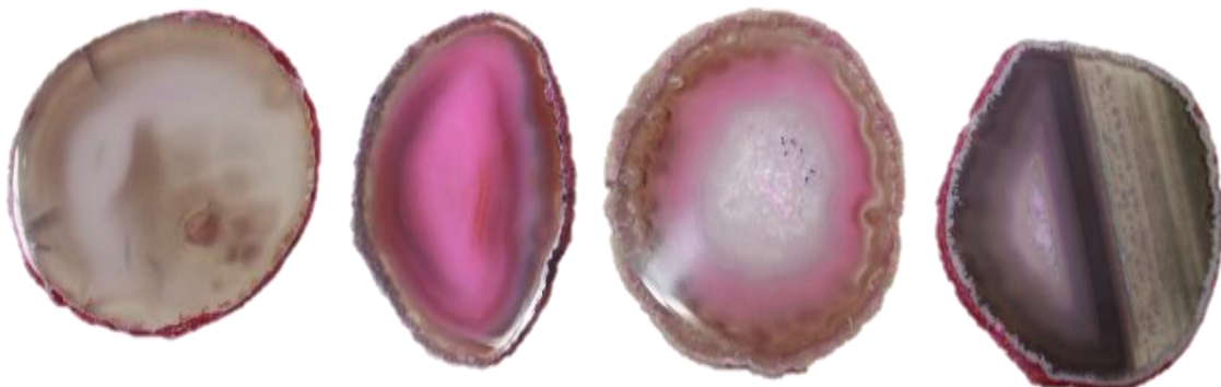
Figura 9 - Amostras de lâminas de ágata com numeração 17, da categoria “vidrada” (17V1 e 17V2), seguida da categoria “bandada” (17B1 e 17B2), “sal” (17S1e 17S2) e “massa” (17M1 e 17M2), da esquerda para a direita. Amostras submetidas ao tingimento em rosa orgânico, para a concentração 1, após polimento das peças.
