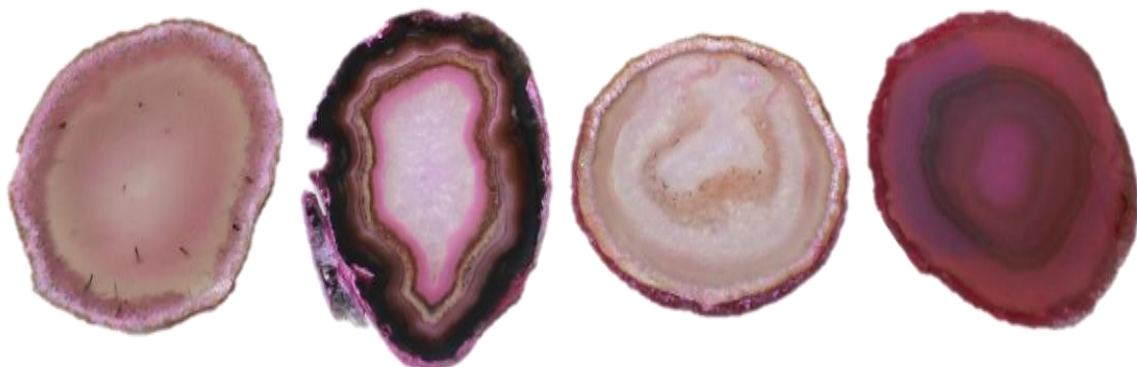
Figura 11 - Amostras de lâminas de ágata com numeração 18, da categoria “vidrada” (18V1 e 18V2), seguida da categoria “bandada” (18B1 e 18B2), “sal” (18S1e 18S2) e “massa” (18M1 e 18M2), da esquerda para a direita. Amostras submetidas ao tingimento em rosa orgânico, para a concentração 2, após polimento das peças.
