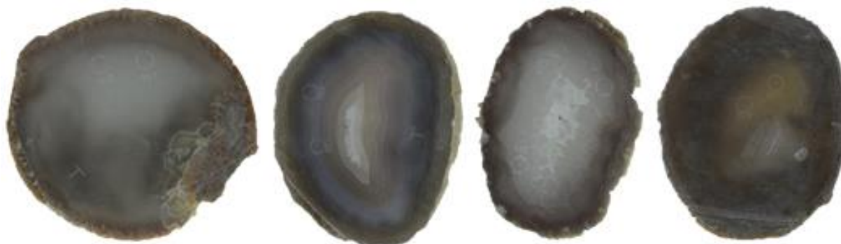
Figura 14 - Amostras de lâminas de ágata com numeração 5, da categoria “vidrada” (5V1 e 5V2), seguida da categoria “bandada” (5B1 e 5B2), “sal” (5S1e 5S2) e “massa” (5M1 e 5M2), da esquerda para a direita. Amostras submetidas ao tingimento em rosa orgânico, para a concentração 4, antes do tingimento.
