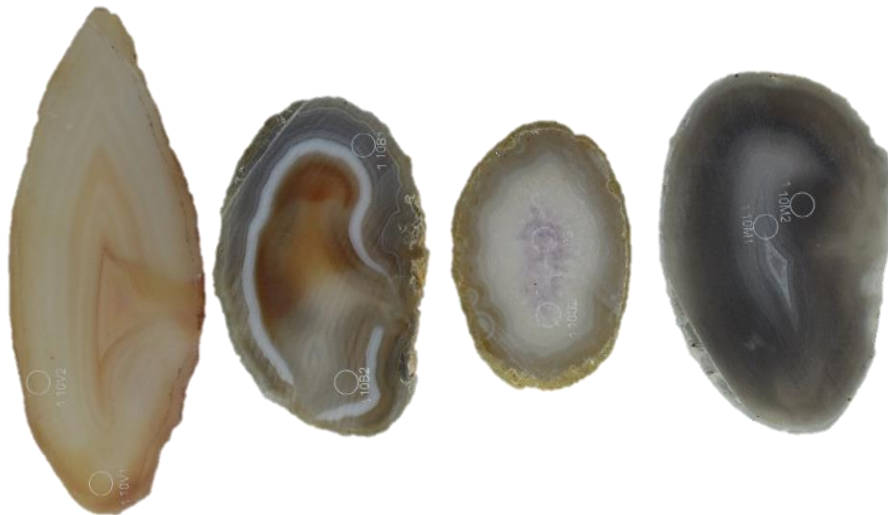
Figura 16 - Amostras de lâminas de ágata com numeração 110, da categoria “vidrada” (110V1 e 110V2), seguida da categoria “bandada” (110B1 e 110B2), “sal” (110S1 e 110S2) e “massa” (110M1 e 110M2), da esquerda para a direita. Amostras submetidas ao tingimento em rosa orgânico, para a concentração 5, antes do tingimento.
