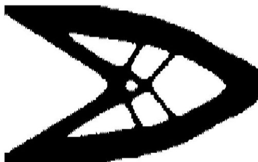
Figura 6 - configuração ótima obtida usando SESO para 11520 elementos triangulares, V = 0,44 V_0
