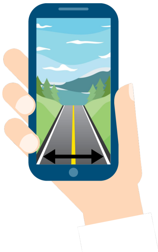
Figura 8: Exemplo de como deve ficar a pista em relação ao dispositivo no momento da coleta da imagem ou vídeo.
