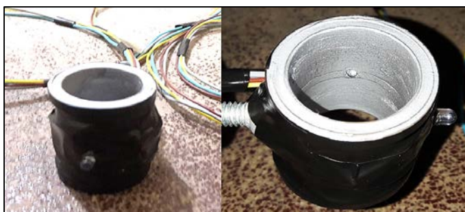
Figura 3: Sensores com os leds para indicação do movimento da esfera
