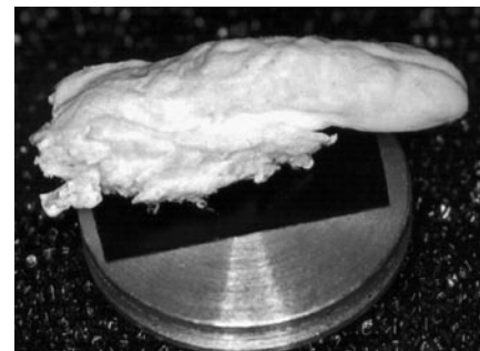
Figura 1 - Molde vascular fixo sobre suporte de alumínio com fita dupla face antes da metalização
