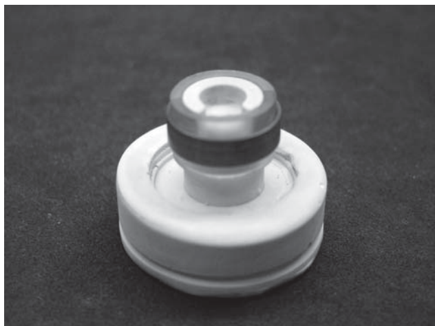
Figura 4 - Anéis acrílicos em posição estabilizado pelo anel metálico
