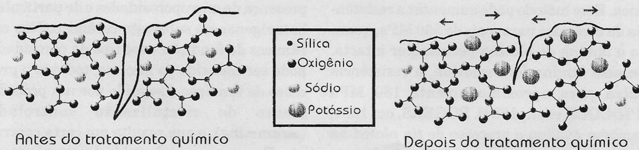
Figura 4 - Desenho esquemático de um tratamento químico por troca iônica sobre a superfície cerâmica.
