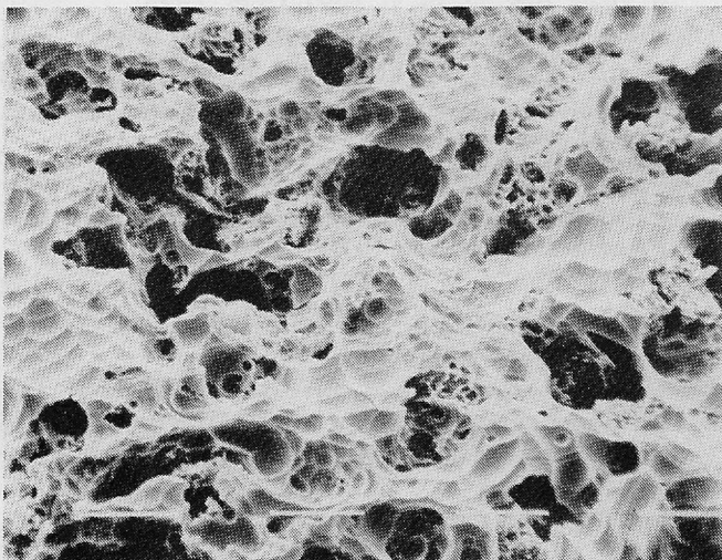
Figura 5 - Microfotografia (1.250X) de microscópio de varredura (Philips SEM 501, Eindhoven, Holanda) mostrando o padrão retentivo da superfície cerâmica (Vita VMK68, dentina 541-A, batch: 1485), atacada por ácido hidrófluorídrico a 9.6% (Mirage Dental Systems, Chameleon Dental Products Inc., Kansas City, KS, EUA) por 2 minutos. As barras brancas marcam 10 µm.
