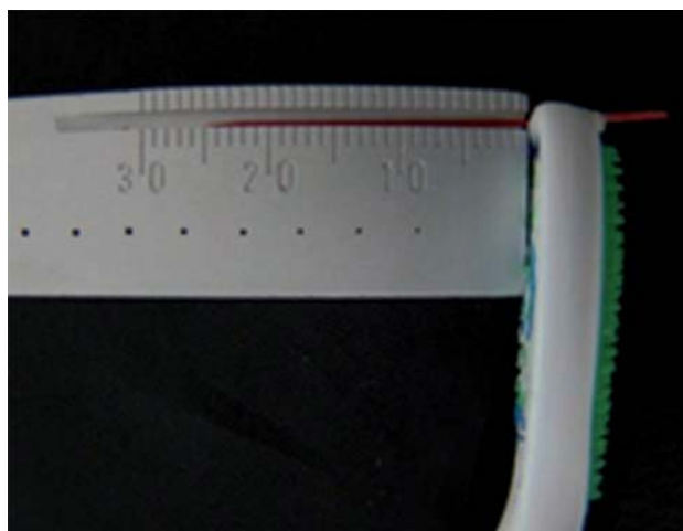
Figura 2 - Transfixação do fio de nylon de 25 mm na escova
