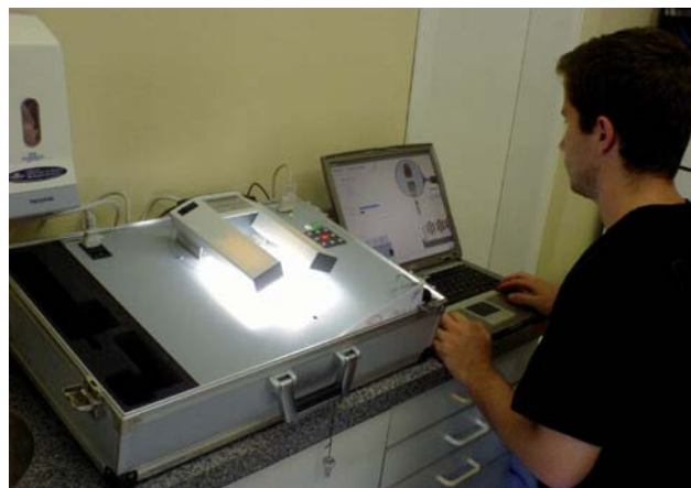
Figura 9 - Indivíduo realizando o teste do TTB com a utilização do software e com o iluminante D65
