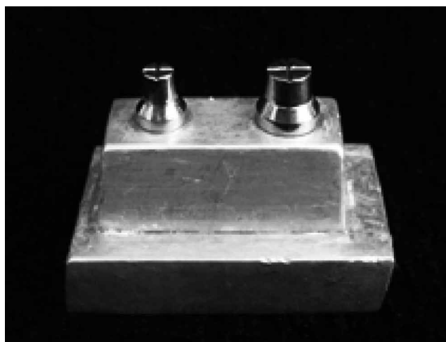
Figura 1 - Modelo mestre em aço inox
