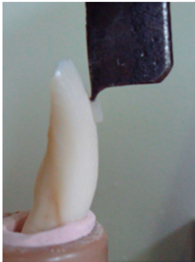
Figura 1 - Corpo-de-Prova disposto na máquina universal
