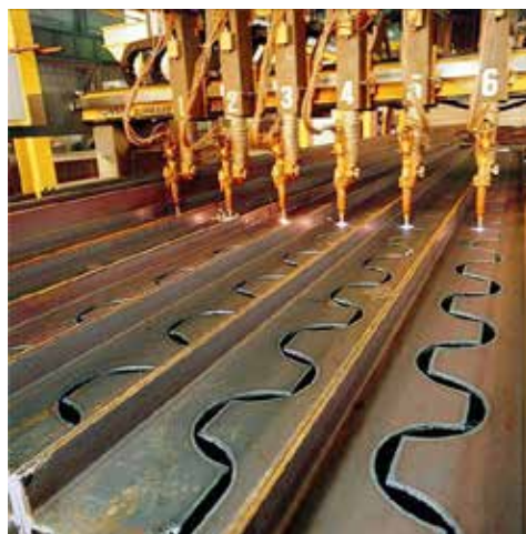
Figura 2: Fabricação de vigas celulares (Feldmann et al 2006)
