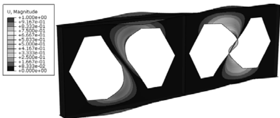
Figura 8: Modo de flambagem representado no ABAQUS para o modelo correspondente à viga 10-5, ensaiada por Redwood e Demirdjian (1998)
