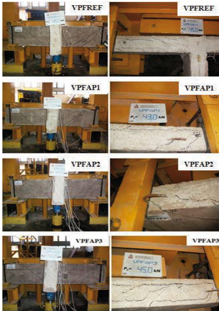
Figura 7: Camadas de concreto dos conjuntos preformados após a ruptura
