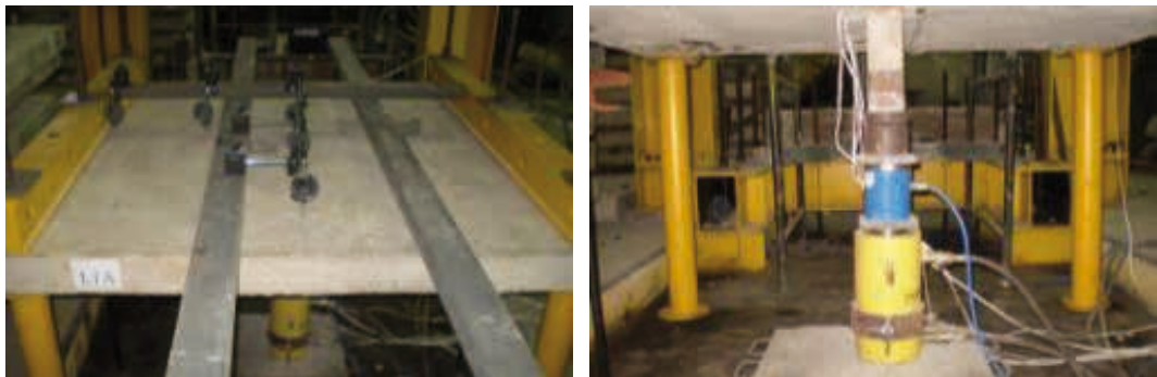
Figura 7: Sistema de ensaio das lajes
