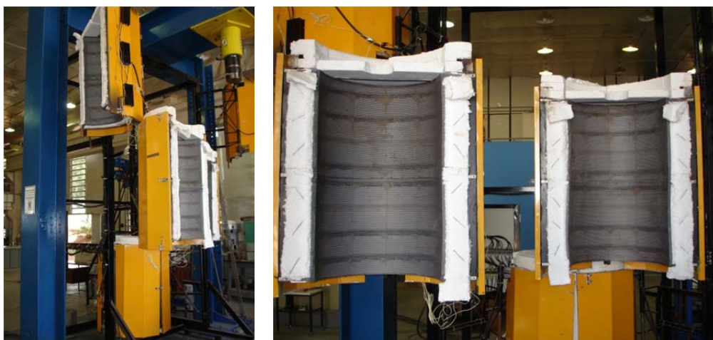
Figura 1: Forno vertical FEC-UNICAMP e detalhe do interior de um de seus 3 módulos.
