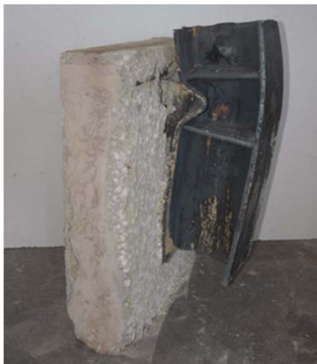
Figura 8: Modo de rotura dos provetes ensaiados a altas temperaturas.
