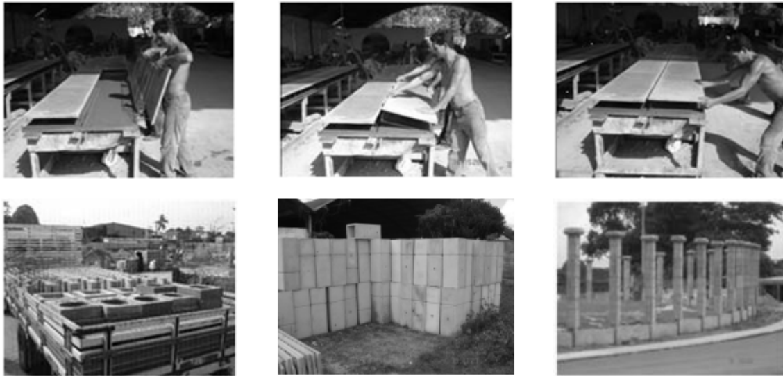
Figura 1: Fabricação, transporte, estocagem e montagem de elementos pré-formados
