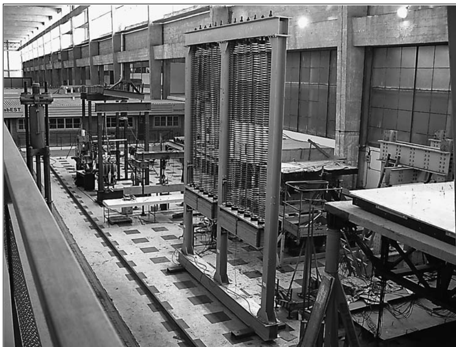
Foto 2: Unidade protótipo (Pórtico com 2 ADS's) para ensaios no LABEST-COPPE/UFRJ
