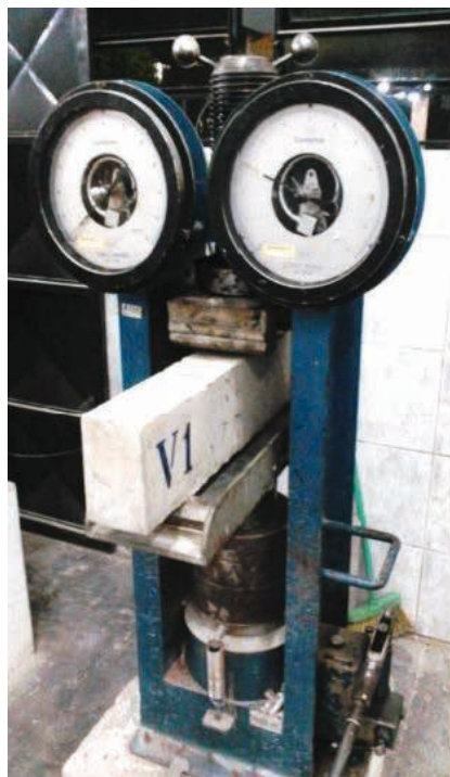
Figura 7: Ensaio de Stuttgart em prensa hidráulica
