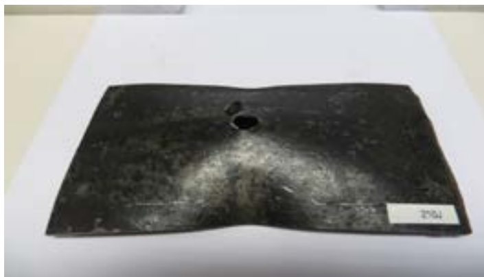
Figura 5: Espécimen S6 después del impacto (210 J)
