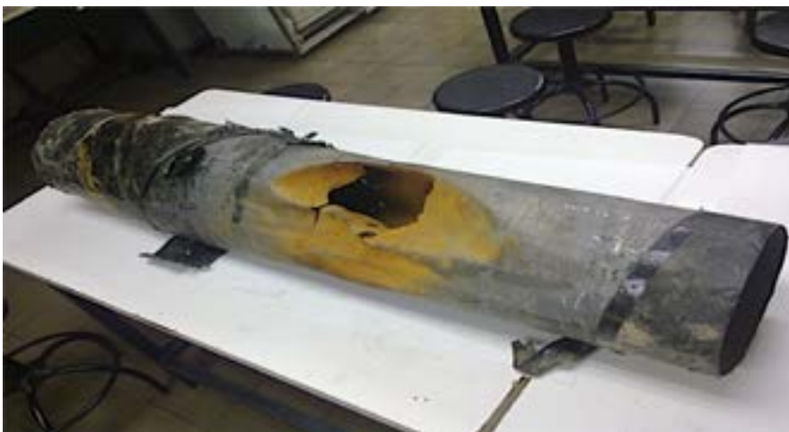
Figura 1: Daños observados en la tubería
