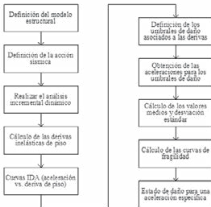
Figura 1: Flujograma para la determinación de curvas de fragilidad con base en los resultados del análisis incremental dinámico
