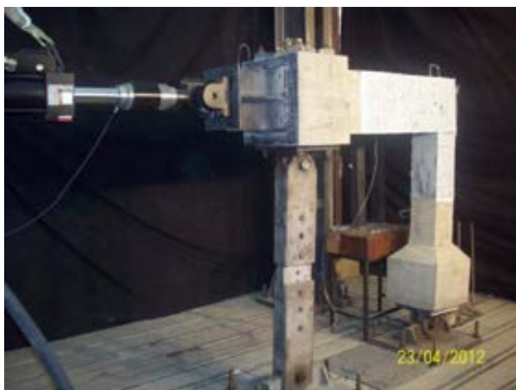
Figura 1: Aplicación de la Historia de desplazamiento en los especímenes durante el ensayo a través del actuador hidráulico
