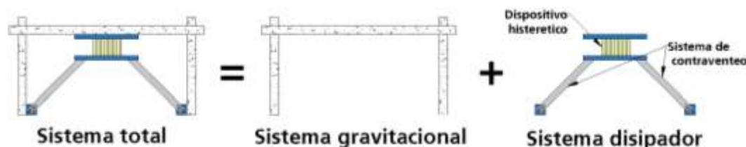
Figura 1: Sistema de marcos de concreto reforzado con contraventeo y disipador
