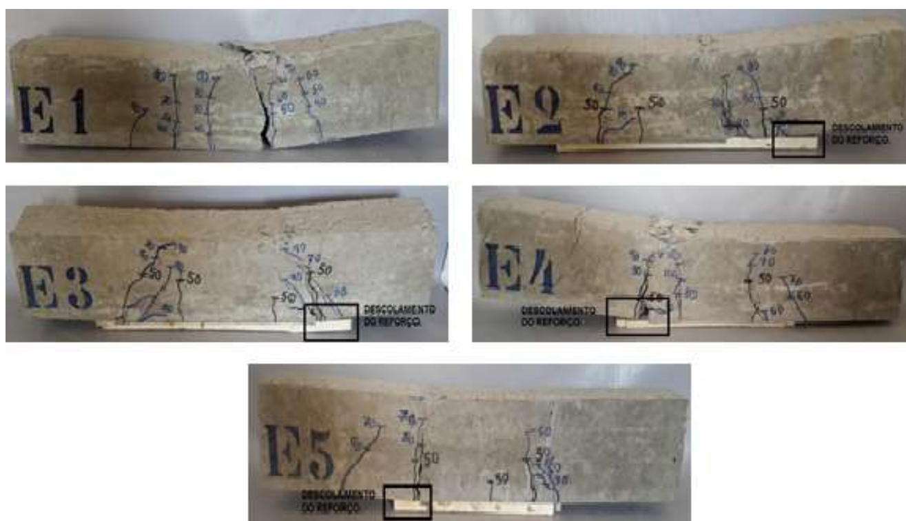
Figura 12 - Vigas E1, E2, E3, E4 e E5 após ruptura.
