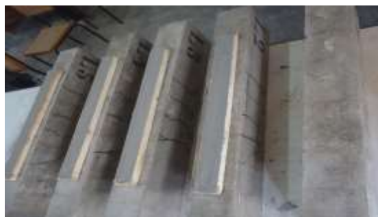
Figura 3 – Vigas reforçadas e viga de referência
