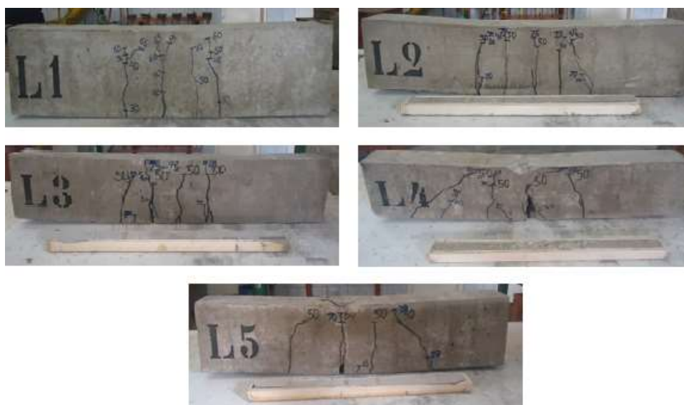
Figura 4 - Vigas L1, L2, L3, L4 e L5 após ruptura.
