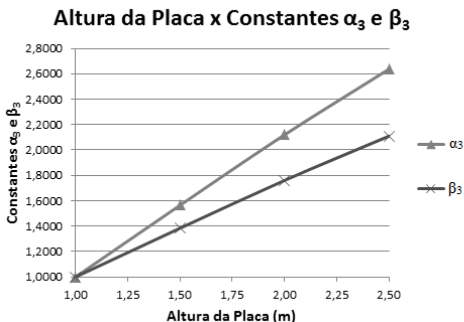
Figura 11 – Gráfico da altura da viga pelos coeficientes \alpha_3 e \beta_3
