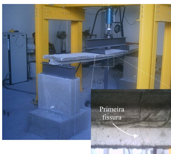
Figura 8 – Configuração do ensaio de flexão das vigas e indicação da fissuração
